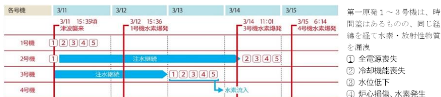
【1～4号機の過酷事故の経緯】 ※出典：福島大学HP「なぜ、福島第一原子力発電所の事故が起こったのか？」より
