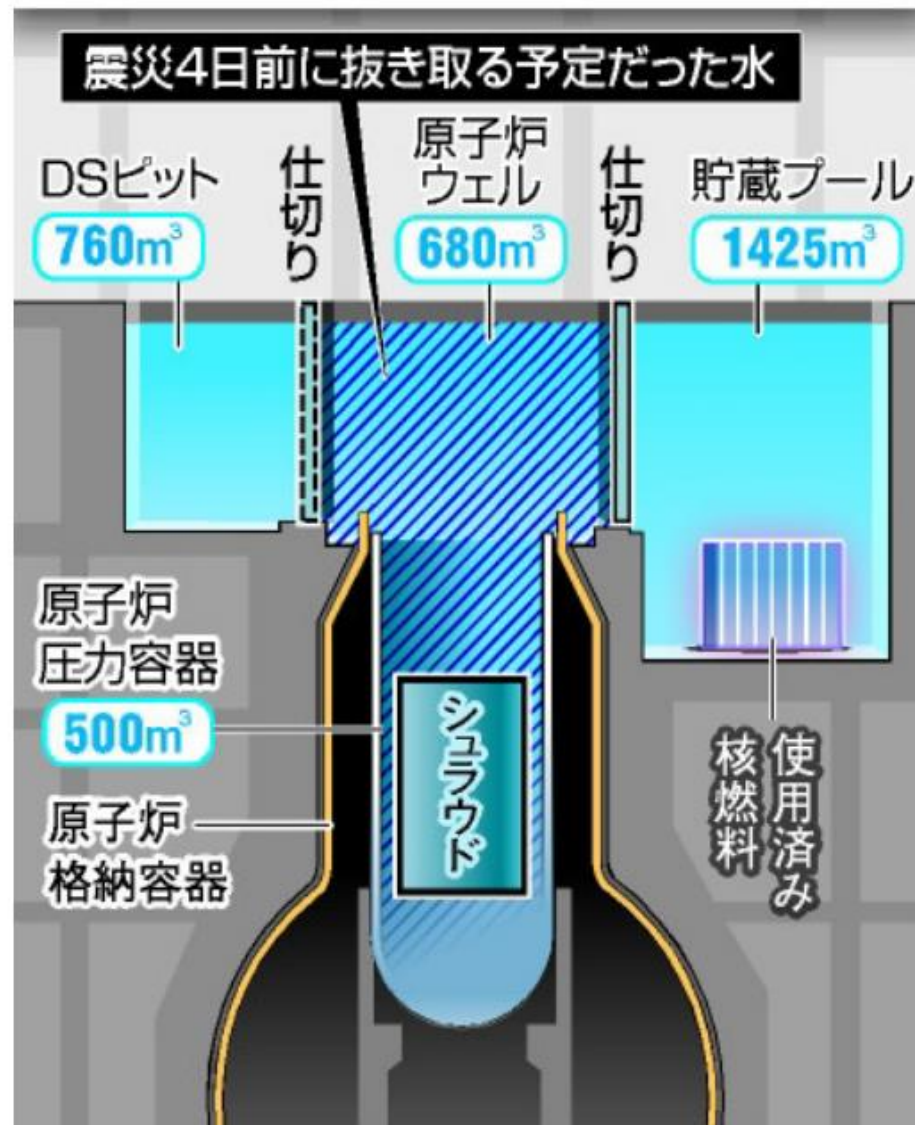
震災当日の4号機の水の状況
