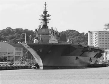
護衛艦「いずも」ヘリコプター搭載型の護衛艦。全長240M、乗員470人。固定翼機の離発着が可能な空母への改修が進む
