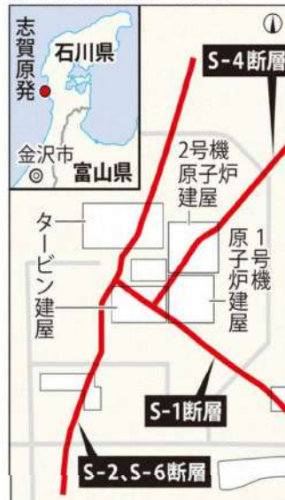
志賀原発 原子炉建屋付近の断層
