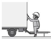
テールゲートリフターを昇降設備として使用する場合は、中間位置で停止させてステップとして使用してください。
